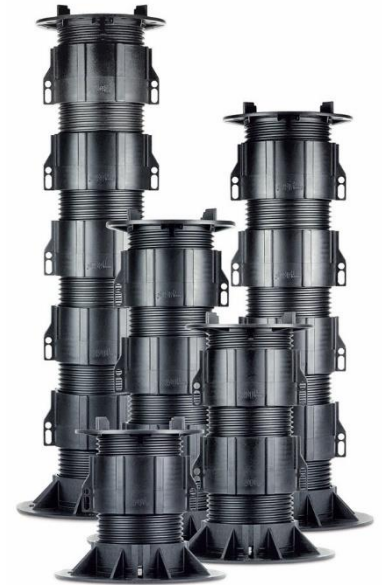
Abb. 14: Höhenverstellbares Terrassenlager PLV50/75 mit 1-5 Zwischenstücken ZSt65/100, Höhenausgleich von 135-550 mm.
